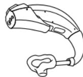
1. Alinee la punta de su adaptador DAI con la ranura en la parte superior del portapilas
