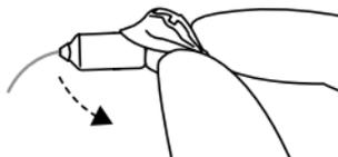
3. Compruebe que el acoplador está bien montado levantando con cuidado la parte inferior del mismo para comprobar que el collar cubre completamente el extremo acanalado del auricular.
