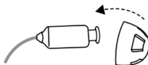
2. Empuje el nuevo acoplador sobre el extremo acanalado del auricular.
