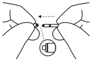
1. Inserte el otro extremo de la herramienta en la salida de sonido (el extremo con el filtro de repuesto).
