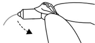
3. Compruebe que el acoplador está bien montado levantando con cuidado la parte inferior del mismo para comprobar que el collar cubre completamente el extremo acanalado del auricular.
