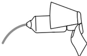
3. Compruebe que el acoplador de tulipán está bien montado verificando que el collar cubre completamente el extremo acanalado del auricular.
