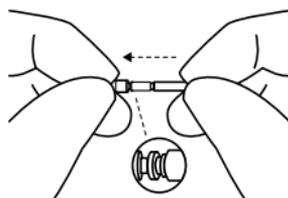
2. Introduzca suavemente el recambio directamente en la salida de sonido hasta que el anillo exterior toque la salida de sonido.
