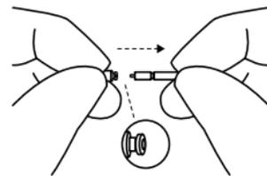
3. Tire de la herramienta directamente hacia fuera - el nuevo filtro anticerumen permanecerá en su lugar. Vuelva a colocar el acoplador o uno de repuesto.
