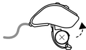
1. Abra el portapilas con la uña. Retire la pila antigua (si hay una).
